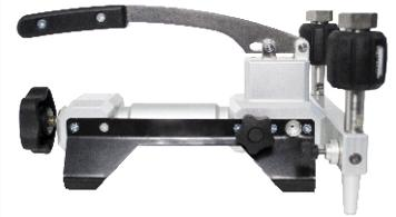
Помпа пневматическая МС-201/207/209 для создания давления при калибровке, поверке или ремонте средств измерения давления. Помпа имеет два посадочных места для эталонного и поверяемого средства измерения, что позволяет производить поверку средств измерения давления методом сравнения.
