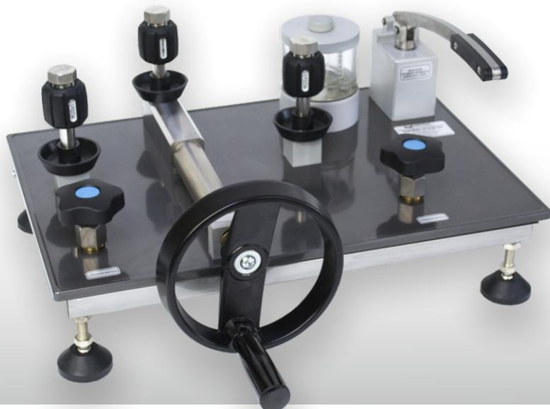
МС-213 - это стационарный гидравлический пресс для создания давления при калибровке, поверке или ремонте средств измерения давления. Пресс имеет три посадочных места (одно для эталонного и два для поверяемых средств измерения), что позволяет производить поверку средств измерения давления методом сравнения.
