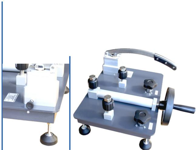
МС-210 — это стационарная пневматическая помпа для создания давления при калибровке и поверке средств измерения давления. Помпа имеет три присоединительных места (одно – для эталонного и два – для поверяемых средств измерения), что позволяет производить поверку средств измерения давления методом сличения.
